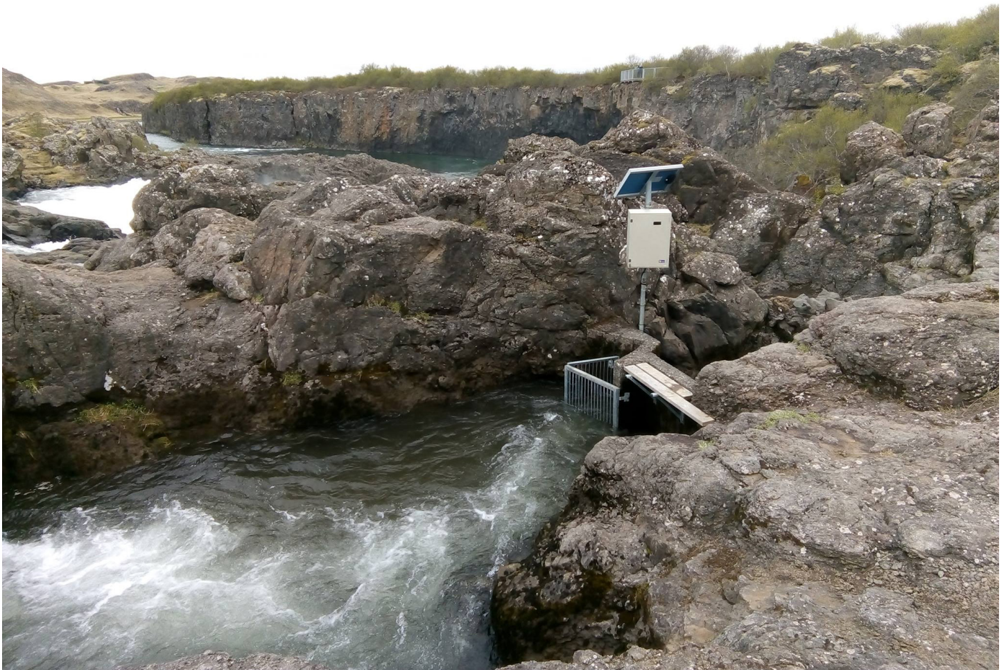
Mynd 34. Laxateljari í fiskvegi við Glanna í Norðurá. Talningar á göngufiski eru mikilvægar til að meta stærð hrygningarstofna og veiðialag í ám. Mynd: Hlynur Bárðarson
